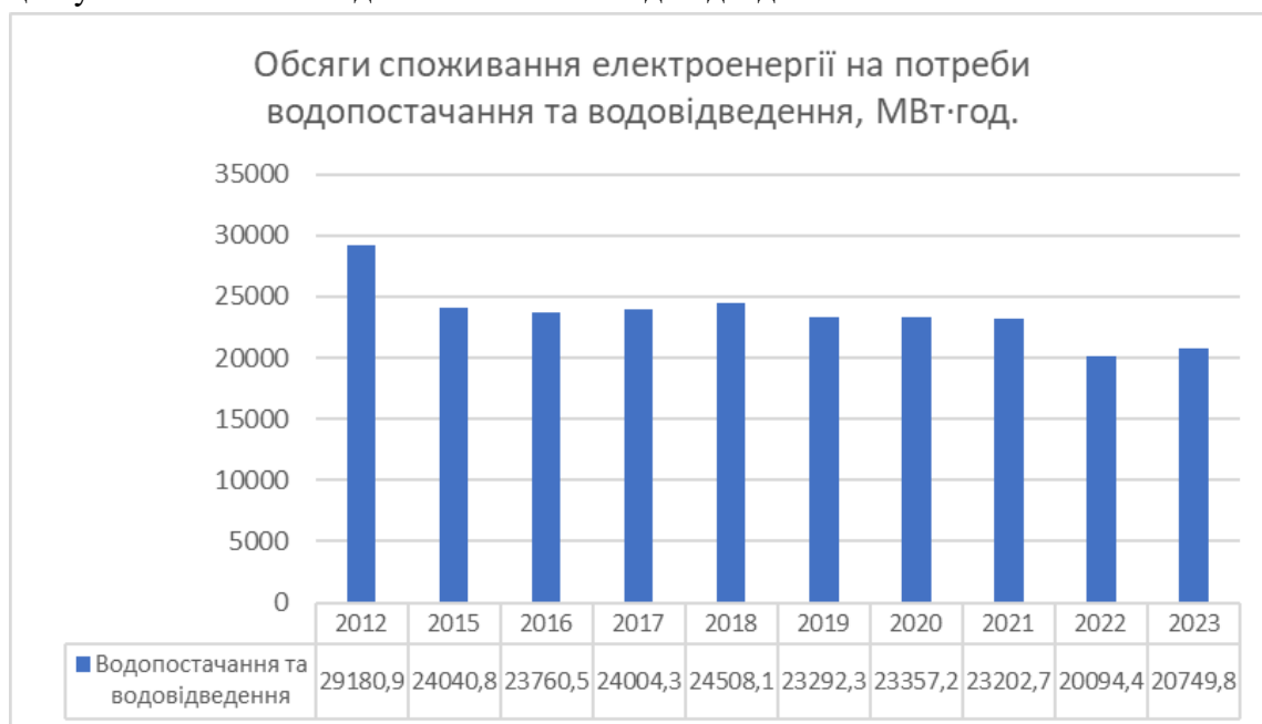
Рис. 3.12. Споживання електроенергії КП «Тернопільводоканал» на потреби водопостачання та водовідведення.
