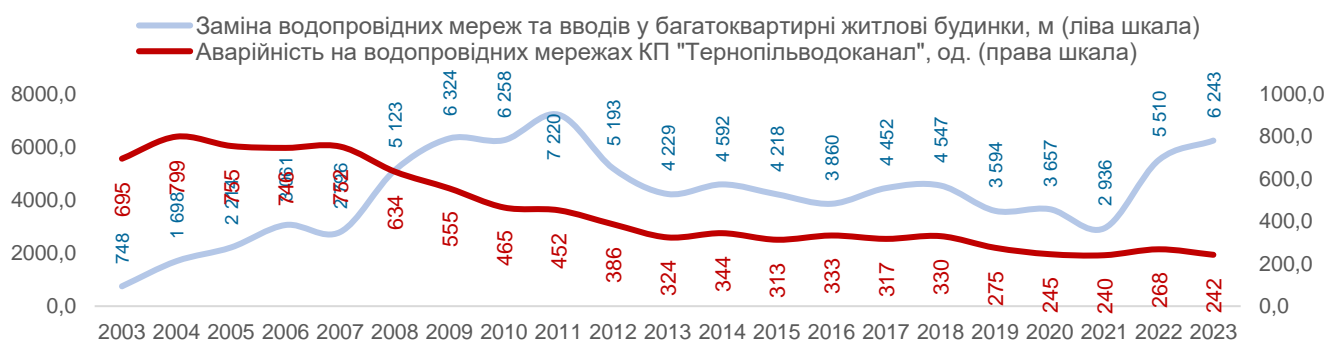
Рис. 5.2.3. Динаміка заміни водопровідних мереж у Тернополі та кількості аварійних випадків на цих об'єктах, 2003-2023 рр. 47
